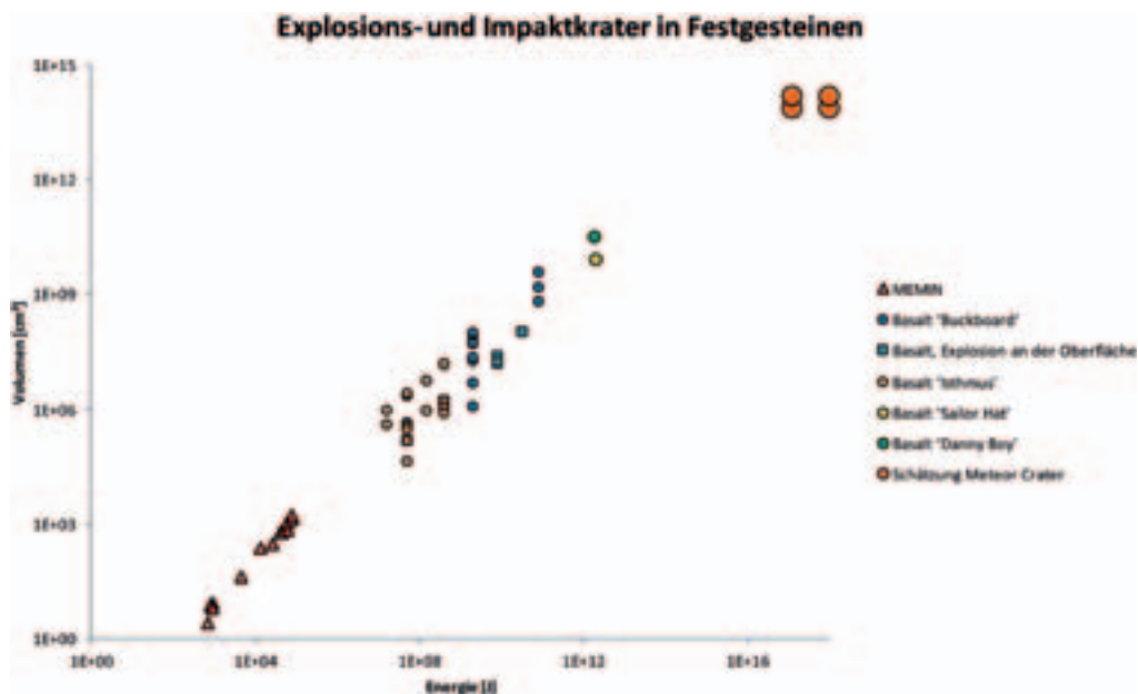
Abb. 9: Ein Vergleich zwischen cm-großen Labor-Impaktexperimenten, m-großen Explosionskratern und dem 1,2 km großen Meteorkrater zeigt, dass bei der Skalierung die Schwerkraft berücksichtigt werden muss.
