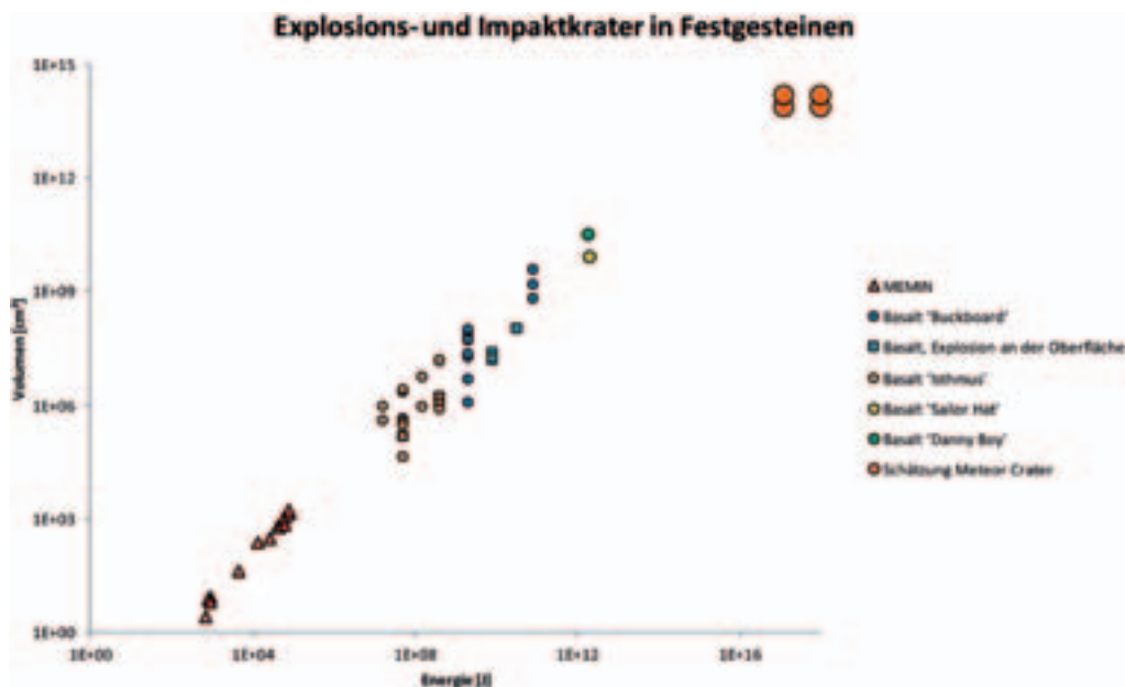
Abb. 9: Ein Vergleich zwischen cm-großen Labor-Impaktexperimenten, m-großen Explosionskratern und dem 1,2 km großen Meteorokrater zeigt, dass bei der Skalierung die Schwerkraft berücksichtigt werden muss.
