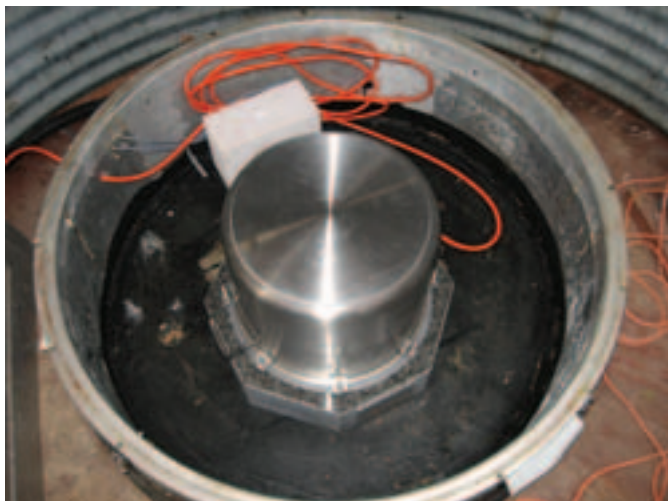
Abb. 2: Breitband-Seismometer vom Typ Streckeisen STS-2 (GRF-Array, Element C 3 ). Das Instrument befindet sich in einem 4,45 m tiefen Schacht. Zur besseren Ankopplung an den Untergrund steht es auf einer Platte aus Gabbro.
