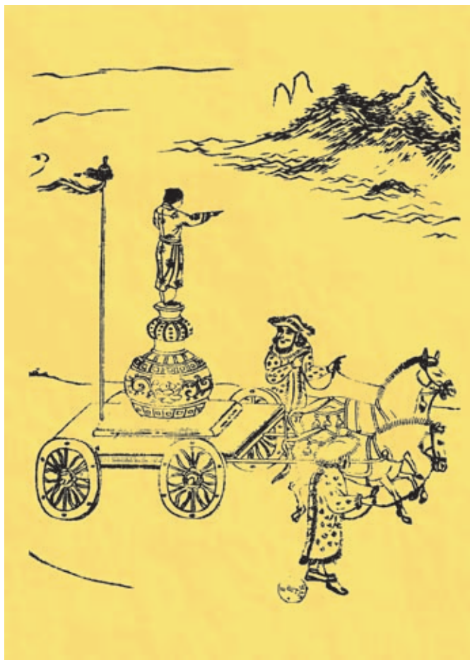
Abb. 2: Chinesischer Kompasswagen. Die bewegliche Figur trägt im ausgestreckten Arm eine Magnetstange und zeigt damit die Südrichtung an (Darstellung aus dem 3. Jahrhundert v. Chr., Bibliothèque Nationale, Paris).
