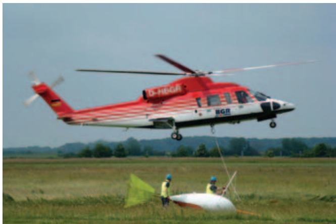
Abb. 8: Aufnahme des Schleppkörpers des IPHT zu einem Erkundungsflug
