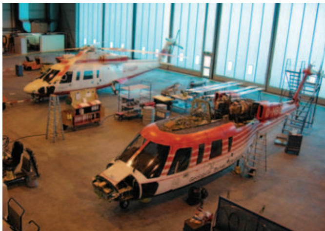
Abb. 2: Die S-76B bei der Überholung in der Flugwerft der Fa. Wiking Helikopter Service GmbH in Wilhelmshaven. Foto: BGR
